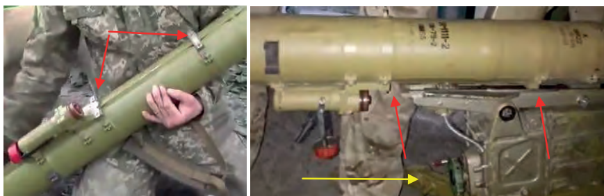
Малюнок 5.1.7 – Встановлення ракети на пускову установку. Червоні стрілки – кріпінж контейнеру ракети; Жовта стрілка – напрям руху ракети по положкам
