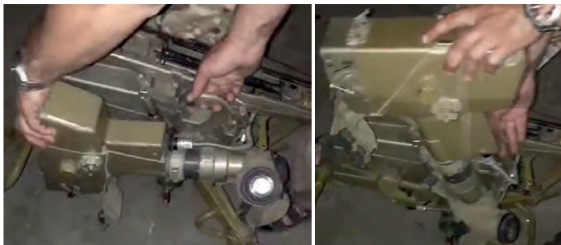
Малюнок 5.1.4 – Підняття прицілу у бойове положення
