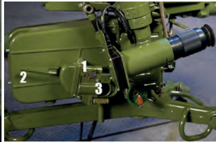
Малюнок 5.1.12 – Зліва: пуск ракети з перевищенням, червона крапка біля перехрестя – видимий в оптику трасер ракети; Справа: 1-запобіжник, 2-рукоятка зведення, 3-спусковий гачок
