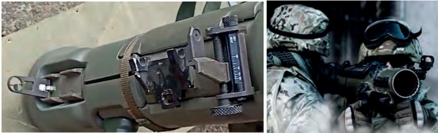
Малюнок 3.14.19 – Механічний приціл з мушкою; справа – прицілювання в Grg
