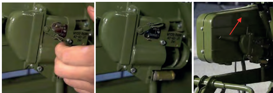
Малюнок 5.1.8 – Зліва направо: Запобіжник в похідному положенні; Запобіжник в бойовому положенні; Зведення пускового механізму, стрілка – напрям руху
