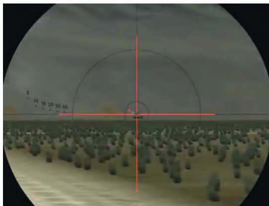
Малюнок 5.1.14 – Доведення ракети до цілі, червона крапка біля перехрестя – видимий в оптику трасер ракети
