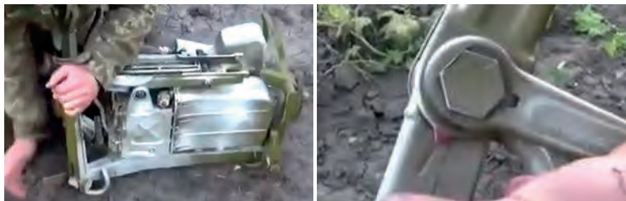
Малюнок 5.1.3 – Розкриття ніг станіни; Фіксація по червоній мітці
