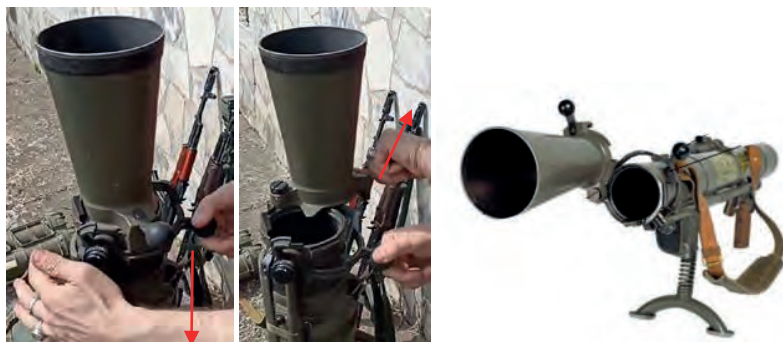
Малюнок 3.14.16 – Віджимання запірного пристрою (зліва) та відкриття затвору (по центру); стрілки – напрям руху
