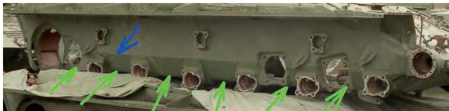
Малюнок 4.1.13 – Та ж 20-ти мм ділянка борту танків Т-72/Т-90 – показана зеленими стрілками, розташована нижче зварювального шва верхнього листа борту – позначена синьою стрілкою. Т-80БВ має таку ж саму 20-ти мм ділянку борта
