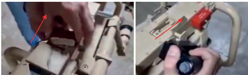
Малюнок 5.4.3 – Зліва – зняття заглушки; Справа – ручка пуску, перед нею переставлена заглушка; червона стрілка – напрям руху ручки пуску
