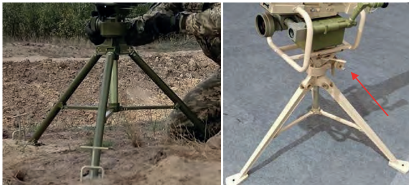
Малюнок 5.4.2 – Встановлення триноги та пускової. Червона стрілка – ричаг кріплення
