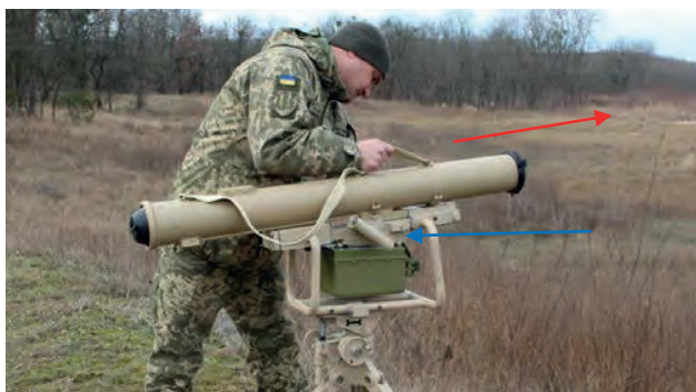
Малюнок 5.4.5 – Встановлення ракети. Червона стрілка – напрям руху при з'єднанні; Синя стрілка – ручка пуску
