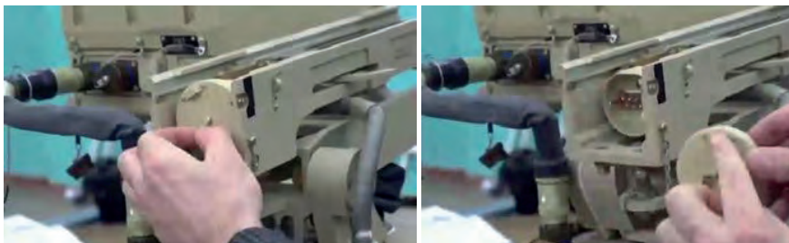
Малюнок 5.5.8 – Заглушка встановлена (зліва) та знята (справа)
