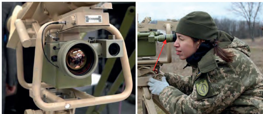
Малюнок 5.4.4 – Лазерний та оптичний канали; Стрілка – окуляр прицілу
