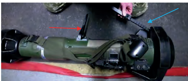
Малюнок 5.7.10 – Червона стрілка: плічковий упор; Синя стрілка: поясний упор
