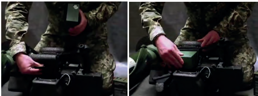
Малюнок 5.6.4 – Встановлення батареї живлення (вистачає на 2 пуски)
