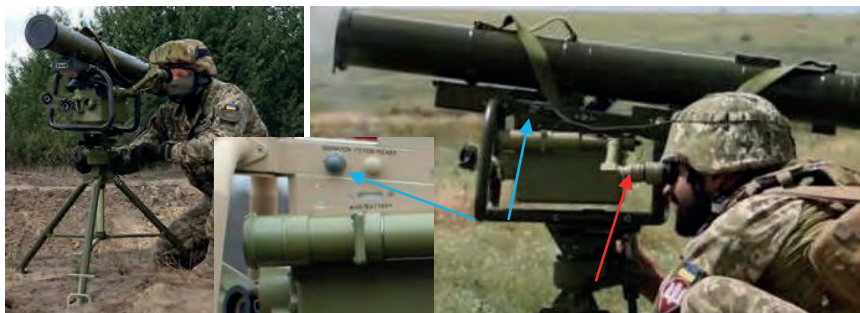
Малюнок 5.4.7 – Позиція для стрільби. Червона стрілка – окуляр прицілу; Синя стрілка – кнопка активізації комплексу
