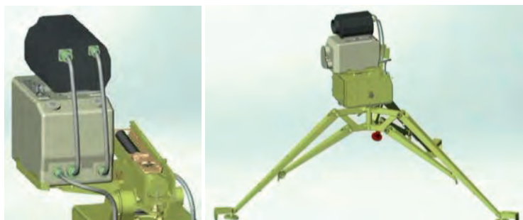
Малюнок 5.5.6 – Кріплення ТПВ та його кабелів
