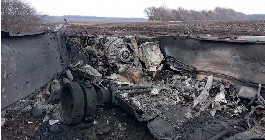
Малюнок 5.7.2 – Танк Т-80БВ армії РФ, знищений Холодноярівською піхотою ЗС України за допомогою ПТРК «NLAW», ніяка ДЗ не допомогла – детонація БК, зрив бапти, розрив корпусу вицент. Добре видно тонкий, 20 мм, нижній лист борту корпусу
