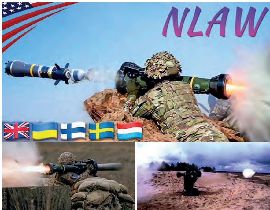
Малюнок 5.7.14 – Двигун ракети запускається на безпечній від стрілка відстані
