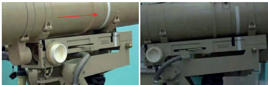
Малюнок 5.5.9 – Встановлення та фіксація ракети, стрілка – напрям руху
