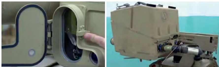
Малюнок 5.5.5 – Відкриття вікна приладу наведення ПН-І (зліва) та з'єднання кабелю живлення приладу наведення
