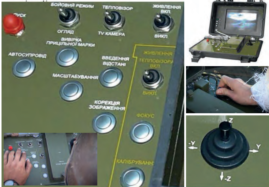
Малюнок 5.5.10 – Органи управління пульта керування, справа – джойстик точного наведення ракети на ціль
